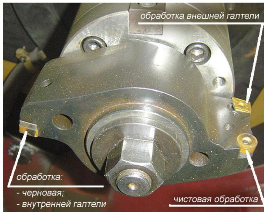
**Рис. Инструментальный блок.**
