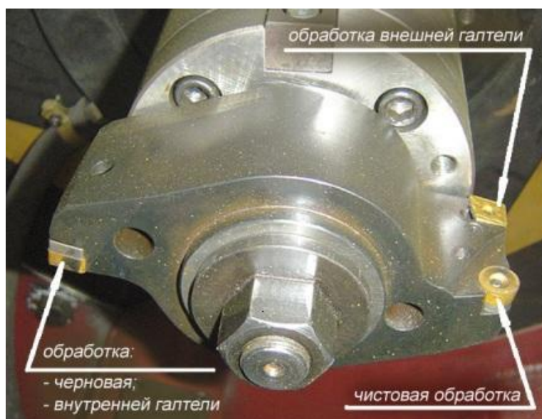
Расточной блок с режущими пластинами
